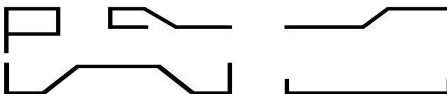
Рис. 5 Формы изгиба арматуры
