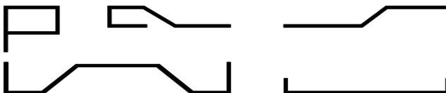
Рис. 5 Формы изгиба арматуры
