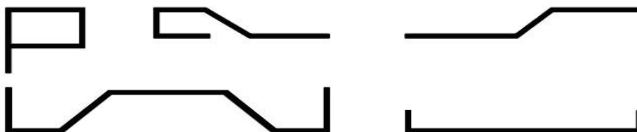
Рис. 5 Формы изгиба арматуры
